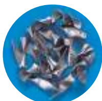
SUS304 EX-SUS-GDR ø 8,5 Velocidade: 18 m/min. Avanço: 0,2 mm/rot.
