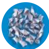
A7075 EX-SUS-GDR ø 8,5 Velocidad: 50 m/min. Avance: 0,45 mm/rot.
