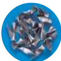
SUS304 EX-SUS-GDR ø 8,5 Velocidad: 18 m/min. Avance: 0,2 mm/rot.
