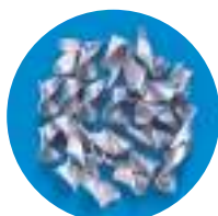
A7075 EX-SUS-GDR ø 8,5 Velocidade: 50 m/min. Avanço: 0,45 mm/rot.
