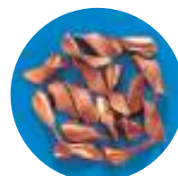
C1020 EX-SUS-GDR ø 8,5 Velocidade: 32 m/min. Avanço: 0,24 mm/rot.
